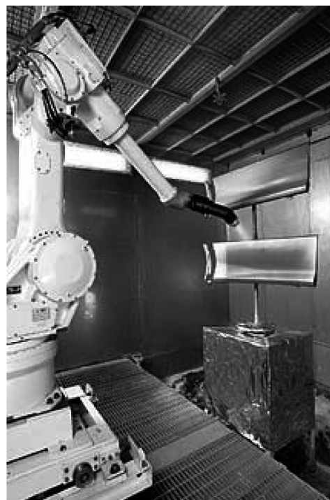
図4 CTC に設置された塗装実験設備の一例 (大型塗装ロボットブース)
