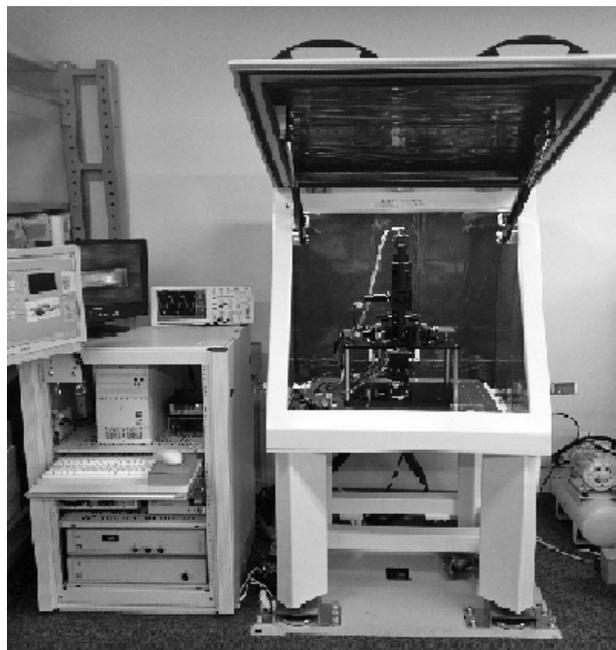
図 1 静電気力顕微鏡全体図
