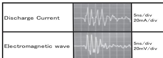
図5 放電電流波形と誘起電圧波形
