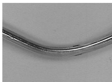
図 15 30 回曲げ試験後の PLLA 電線
